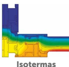
$U_F \geq 1,51 \text{ w/m}^2\text{°k}$  Según UNE-EN-ISO-10077-2
